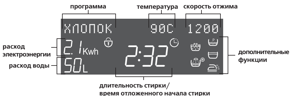
Рисунок 13 — Зоны индикации дисплея
