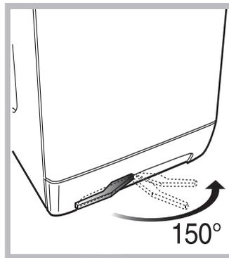
Ваша стиральная машина может быть оснащена специальными убирающимися колесами для облегчения ее перемещения. Чтобы опустить колеса и передвинуть оборудование, просто потяните за рычаг, расположенный слева под основанием машины. После установки оборудования в требуемое положение верните рычаг в исходное поло.
