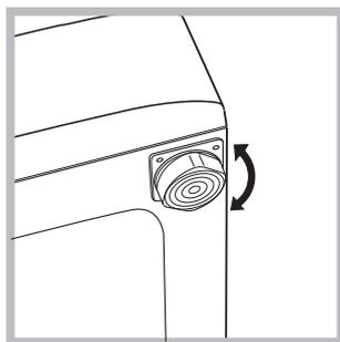
(см. рис.). Для этого сначала ослабьте контргайку, после завершения регулировки контргайку затяните.
