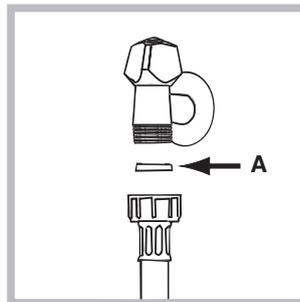
1. Вставьте прокладку А в конец заливного шланга и наворачите его на вывод водопровода холодной воды с резьбовым отверстием 3/4 дюйма (см. рис.). Перед подсоединением откройте водопроводный кран и дайте стечь грязной воде.
