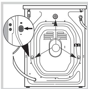
3. Odstraňte 3 šrouby s gumovou podložkou a s příslušnou rozpěrkou, nacházející se v zadní části (viz obrázek), sloužící na ochranu během přepravy.
