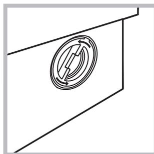
2. odkrúťte vrchný kryt jeho otáčaním proti smeru hodinových ručičiek (vid' obrázok): vytečenie malého množstva vody je celkom bežným javom;
