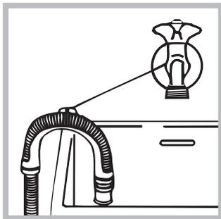
В случае крепления на край ванной или раковины, шланг вешается с помощью направляющей (входит в комплект поставки), которая крепится к крану (рис.).
