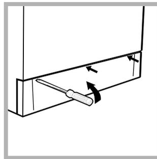
1. уклоните покривни панел на предњем делу машине благим окретањем (види слику);
