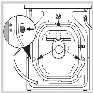
3. Otklonite 3 vijka za zaštitu u prijevozu i gumicu s odstojnikom na stražnjoj strani (vidi sliku).
