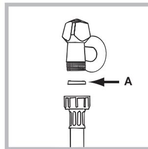
1. Umetnite zaptivač A na završetak dovodne cijevi i spojite na slavinu s hladnom vodom 3/4 narezanog otvora, kao plinski priključak (vidi sliku). Prije spajanja pustite vodu da teče dok ne bude bistra.
