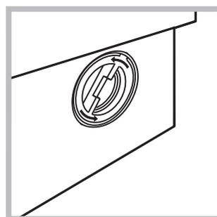
2. odšroubujte vrchní kryt otáčením proti směru hodinových ručiček (viz obrázek): vytečení malého množství vody je zcela běžným jevem;
