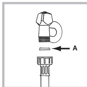
1. Vložte tesnenie A do koncovnej časti prítokovej hadice a pripevnite ju k uzáveru studenej vody so závitom 3/4" (vid' obrázok). Pred pripojením hadice nechajte vodu odtiecť, až kým nebude priehľadná.
