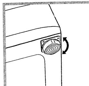
2. После установки машины на место отрегулируйте ее устойчивое положение путем вращения передних ножек (см. рис.). Для этого сначала ослабьте контргайку, после завершения регулировки контргайку затяните.
