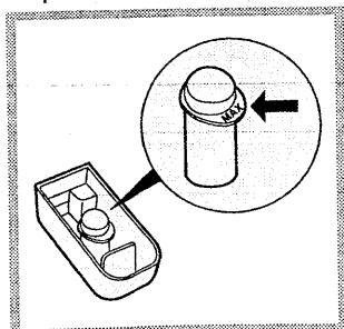
Лоток 4 для отбеливателя вставляется в отделение 1 распределителя моющих средств. Не заполняйте лоток 4 выше отметки max (см. рис.).
