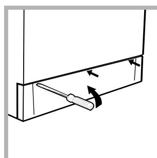
1. снимите переднюю панель Стиральная машина с сушкой при помощи отвертки (см. рис.);
