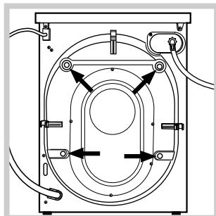
3. Отстранете 4-те винта за предпазване при превоза и гumenата гарнитура със съответната втулка за раздалечаване, поставени в задната част (виж фигурата).
