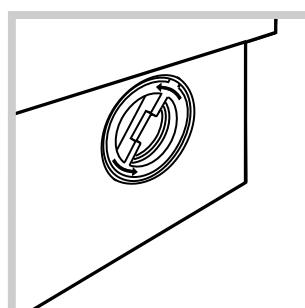
2. выверните крышку фильтра, вращая ее против часовой стрелки (см. рис.): из насоса может выплыть немножко воды – это нормальное явление.
