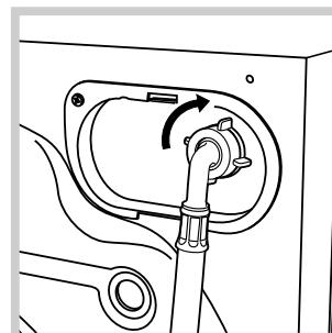
2. Подсоедините заливной шланг к Стиральная машина с сушкой, навинтив его на водоприемник, расположенный в задней верхней части справа (см. рис.).
