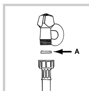
1. Vložte těsnění A do koncové části přítokové hadice a připevněte ji ke kohoutu studené vody se závitem 3/4" (viz obrázek). Před připojením hadice nechte vodu odtékat, dokud nebude čirá.
