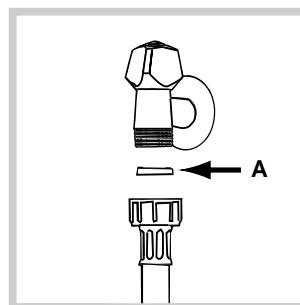
1. Wsunąć uszczelkę A do końcówki przewodu doprowadzającego wodę i przykręcić go do kurka zimnej wody z gwintowanym przyłączem 3/4 (patrz rysunek). Przed podłączeniem spuszczać wodę, aż stanie się ona całkowicie przezroczysta.
