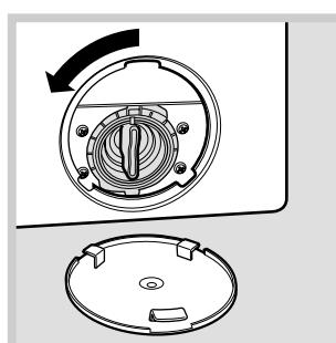
2. отверните крышку фильтра, вращая ее против часовой стрелки (см. рис.), может выплыть немного воды - это нормально;
