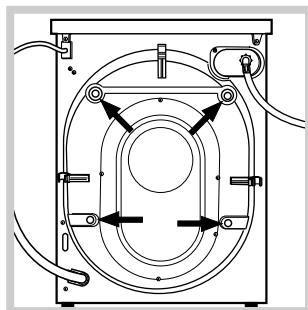
3. Удалите с задней части оборудования 4 транспортировочных болта с установочными резиновыми шайбами (см. рис.).
