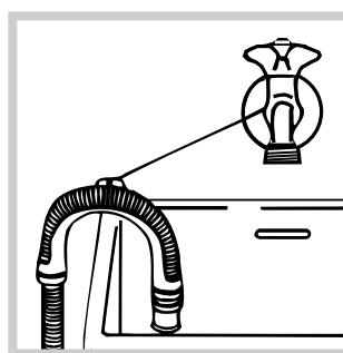
albo oprzeć go na brzegu zlewu lub wannę, przymocowując do kranu prowadnik, znajdujący się w wyposażeniu pralki (patrz rysunek). Wolny kraniec rury usuwania wody nie powinien pozostawać zanurzony w wodzie.
