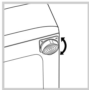
2. V případě, že podlaha není dokonale vodorovná, mohou být případné rozdíly vykompenzovány šroubovaním předních nožek (viz obrázek); Úhel sklonu, naměřený na pracovní ploše, nesmí přesáhnout 2°.
