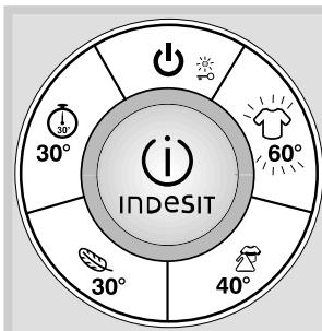
příslušného TLAČÍTKA SPUŠTĚNÍ PROGRAMU. Ikona zvoleného programu se rozsvítí stálým světlem, zatímco kontrolky znázornění prací doby zhasnou. Kontrolka SIGNALIZACE ZABLOKOVÁNÍ DVÍŘEK se rozsvítí stálým světlem, čímž poukazuje na bezpečnostní zablokování dvírek.
