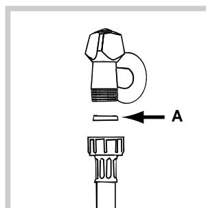
1. Вставьте прокладку A в конец заливного шланга и наверните его на вывод водопровода холодной воды с резьбовым отверстием 3/4 дюйма (см. рис.). Перед подсоединением заливного шланга откройте водопроводный кран и дайте стечь грязной воде.
