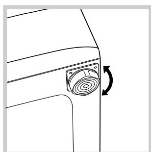
2. Если пол неровный, отрегулируйте устойчивое положение машины путем растяжения ее передних ножек (см. рис.). Угол наклона верхней крышки корпуса не должен превышать 2°.
