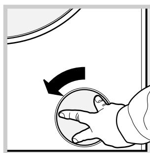
1. снимите внизу передней части стиральной машины защитную покрышку, повернув ее против часовой стрелки (см. рис.);
