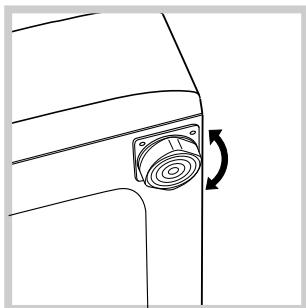
2. Jeśli podłoga nie jest idealnie pozioma, należy skompensować nierówności, dokręcając lub odkręcając przednie nóżki (patrz rysunek); kąt nachylenia, zmierzony na górnym blacie pralki, nie powinien przekraczać 2°.
