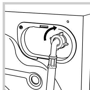
2. Подсоедините заливной шланг к стиральной машине, навинтив его на водоприемник, расположенный вверху справа на задней части оборудования (см. рис.).
