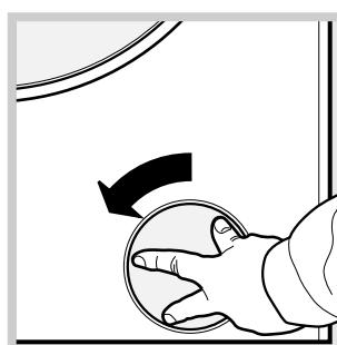
1. odstraňte ochranný kryt nacházející se ve spodní části pračky jeho otáčením proti směru hodinových ručiček (viz obrázek);
