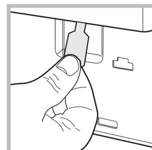
4. потяните наружу язычок, показанный на схеме, вплоть до освобождения пластикового блокировочного винта. Затем потяните его вниз и одновременно откройте люка.
