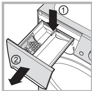
Чтобы вынуть дозатор, нажмите на язычок (1) и вытащите дозатор (2) (см. схему).
