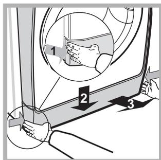
1. снимите переднюю панель стиральной машины, нажав в центре, затем потяните ее вниз за края и снимите ее (см. схемы).
