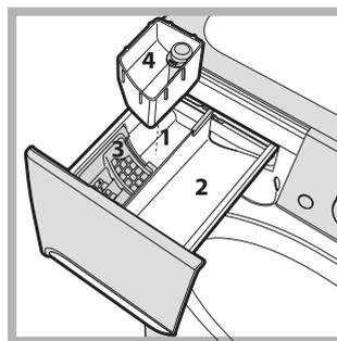
Эта функция служит для удаления наиболее трудных пятен. Вставьте дополнительный прилагающийся дозатор 4 в дозатор 1. При заливе отбеливателя не превышайте "макс." уровень, указанный на стержне в центре (см. схему). Для выполнения только отбеливания залейте отбеливатель в дополнительный дозатор
