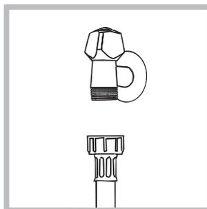
1. Прикрутите шланг подачи к водопроводному крану холодной воды с резьбовым отверстием 3/4 газ, (см. схему). Перед подсоединением откройте водопроводный кран до тех пор, пока из него не потечет чистая вода.
