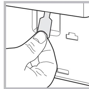
4. за допомогою вказаного на малюнку язичка потягнути пластмасову тягу з упору назовні, аж доки її не буде звільнено; потім потягнути її донизу, одночасно відкриваючи дверцята.
