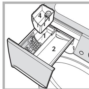
Cette fonction est très utile pour éliminer les taches les plus résistantes. Monter le bac supplémentaire 4 fourni avec l'appareil à l'intérieur du bac 1. Au moment de verser l'eau de Javel, attention à ne pas dépasser le niveau "max" indiqué sur le pivot central (voir figure). Pour n'effectuer qu'un
