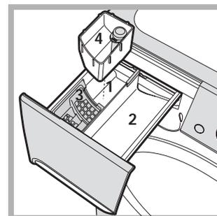
Deze functie is geschikt voor het verwijderen van de hardnekkigste vlekken. Plaats het bijgeleverde bakje 4 in vak 1. Schenk het bleekmiddel en zorg ervoor nooit het "max" niveau, aangegeven op de centrale spil, te overschrijden (zie figuur). Om uitsluitend te bleken giet u het bleekmiddel in het extra bakje 4, stelt u het
