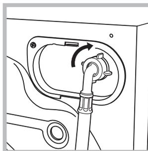
2. Ligue o tubo de alimentação na máquina de lavar roupa atarraxando-o no apropriado fornecimento da água, na parte traseira, em cima à direita (veja a figura).
