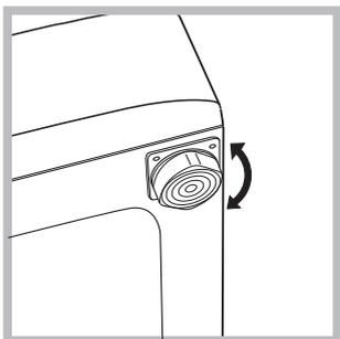
2. Als de vloer niet volledig horizontaal is kunt u de onregelmatigheid opheffen door de stelvoetjes aan de voorkant losser of vastert te schroeven (zie afbeelding); de inclinatiehoek, gemeten ten opzichte van het
