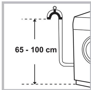
Verbind de buis, zonder hem te buigen, aan een afvoerleiding of aan een afvoer in de muur tussen de 65 en 100 cm van de grond af;
