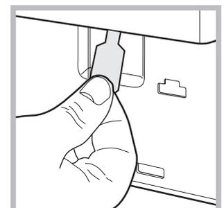
4. utilizando la lengüeta indicada en la figura, tire hacia fuera hasta liberar la varilla de plástico del retén; posteriormente tire hacia abajo y simultáneamente abra la puerta.
