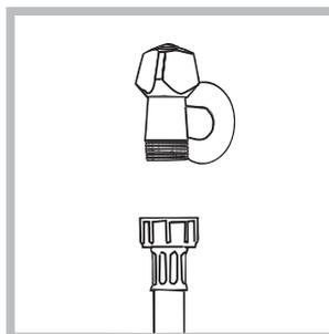
1. Schrauben Sie den Wasserschlauch an einen Kaltwasserhahn mit 3/4-Zoll-Gewindeanschluss an (siehe Abbildung). Lassen Sie das Wasser vor dem Anschluss so lange auslaufen, bis klares Wasser austritt.
