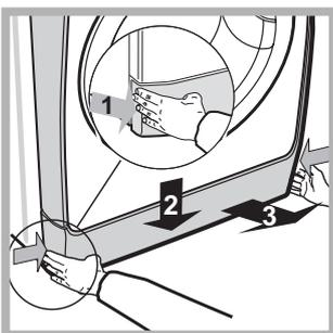
1. Nehmen Sie die Abdeckung an der Gerätefront ab, indem Sie zur Mitte hin drücken, dann drücken Sie beide Seiten nach unten und ziehen sie heraus (siehe Abbildungen).
