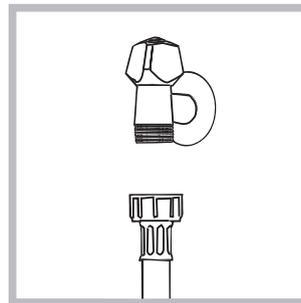
1. Conecte el tubo de alimentación enroscándolo a un grifo de agua fría con la boca roscada de 3/4 gas (ver la figura). Antes de conectarlo, haga correr el agua hasta que esté límpida.
