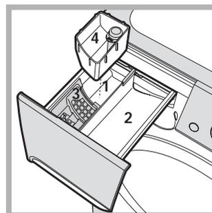
Esta função é útil para eliminar as manchas mais resistentes. Colocar o recipiente adicional 4, fornecido com o produto, no recipiente 1. Quando deitar a lixívia, não ultrapasse o nível “máx” indicado no pino central (veja a figura). Para efectuar somente o branqueamento
