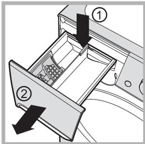
Para extraer el cajón, presione la palanca (1) y tire hacia afuera (2) (ver la figura).
