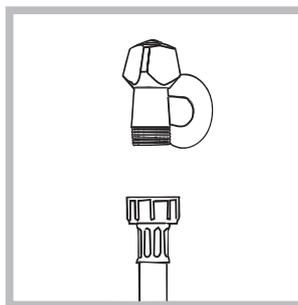
1. Realize a ligação do tubo de alimentação parafusando-o a uma torneira de água fria com bocal de rosca de 3/4 gás(veja a figura). Antes de realizar esta ligação, haja a água escorrer até estar límpida.
