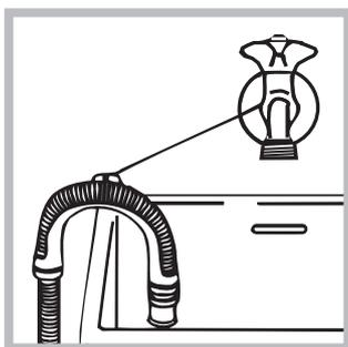
o apóyelo en el borde de un lavamanos o de una bañera, uniendo la guía suministrada con el aparato, al grifo (*ver la figura*). El extremo libre del tubo de desagüe no debe permanecer sumergido en el agua.
