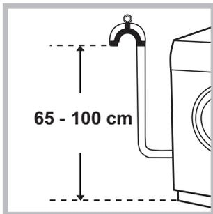
Ligue o tubo de descarga, sem dobrá-lo, a uma condução de descarga ou a uma descarga na parede situada entre 65 e 100 cm de altura do chão;
