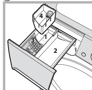
Эта функция служит для удаления наиболее трудных пятен. Вставьте дополнительный прилагающийся дозатор 4 в дозатор 1. При заполнении отбелителя не превышайте "макс." уровень, указанный на стержне в центре (см. схему). Для выполнения только отбеливания залейте отбелитель в дополнительный
