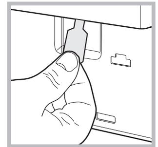
4. за допомогою вказаного на малюнку язичка потягнути пластмасову тягу з упору назовні, аж доки її не буде звільнено; потім потягнути її донизу, одночасно відкриваючи дверцята.
