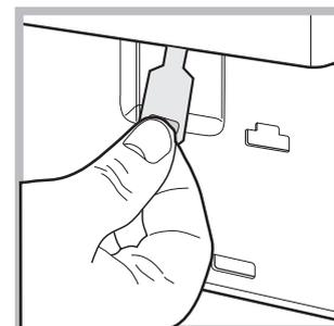
4. потяните наружу язычок, показанный на схеме, вплоть до освобождения пластикового блокировочного винта. Затем потяните его вниз и одновременно откройте люка.
