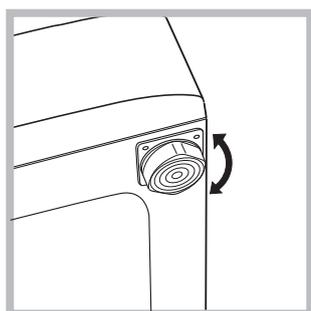
2. Ако подът не е идеално хоризонтален, компенсирате неравностите, като отвиете или завиете предните крачета (виж фигурата); ъгълът на наклона, измерен върху работната повърхност, не трябва да надвишава 2°.
