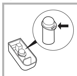
Лоток 4 для отбеливателя вставляется в отделение 1 распределителя моющих средств. Не заполняйте лоток 4 выше отметки max (см. рис.). Для осуществления только отбеливания налейте отбеливатель в дополнительную вставку
