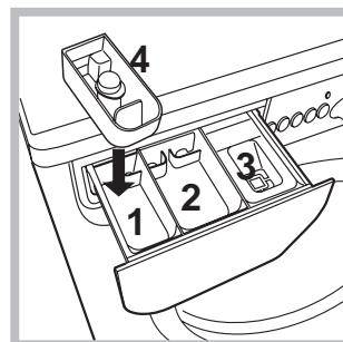
Эта функция служит для удаления наиболее трудных пятен. Вставьте прилагающийся дополнительный дозатор 4 в ячейку 1. Не заливайте отбеливатель в дозатор выше отметки «макс.» на центральной шкале (см. рисунок).
