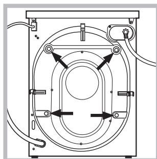
3. Видаліть 4 гвинти для захисту під час транспортування та гумову шайбу з відповідною прокладкою, що знаходиться у задній частині (див. малюнок).
