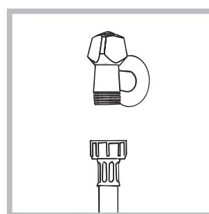
1. Прикрутите шланг подачи к крану холодной воды с резьбовым отверстием 3/4 gas (см. схему).
