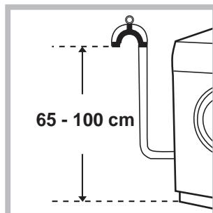
Підключіть зливний шланг, не згиноючи його, до каналізаційного каналу або до входу до такого каналу на стіні, на відстані від 65 до 100 см від підлоги;
