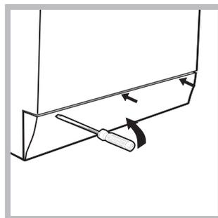
1. scoateți panoul de acoperire din partea din față a mașinii de spălat folosind o șurubelniță (a se vedea figura);
