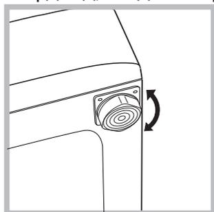
2. Ако подът не е идеално хоризонтален, компенсирате неравностите, като отвиете или завиете предните крачета (виж фигурата); ъгълът на наклона, измерен върху работната
