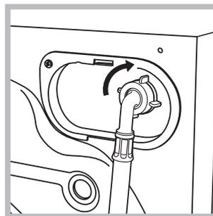
2. Conectați tubul de alimentare la mașina de spălat, înșurubându-l la sursa de apă respectivă, amplasată în partea posterioară, sus în dreapta (a se vedea figura).
