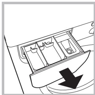
Izvučite pretinac podižući ga i povlačeći prema vani (vidi sliku). Operite ga u tekućoj vodi; ovo čišćenje treba često vršiti.
