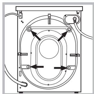
3. Снимите 4 транспортировочных болта, предохраняющие машину в процессе перевозки, и резиновую заглушку с соответствующей распорной шайбой, расположенные в задней части
