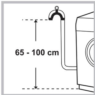
Conectați furtunul de golire - fără a-l îndoi - la canalizare sau la racordul de golire prevăzut pe perete, la o înălțime de 65 - 100 cm de sol;
