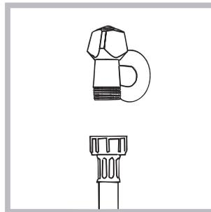
1. Spojite dovodnu cijev navijajući je na slavinu s hladnom vodom nareznog otvora 3/4, kao za plinski priključak (vidi sliku). Prije spajanja pustite vodu da teče dok ne bude bistra.
