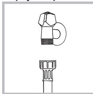
1. Pripojte prívodnú hadicu jej zaskrutkovaním ku kohútiku so studenou vodou s hrdlom so závitom 3/4" (vid' obrázok). Pred pripojením hadice nechajte vodu odtiecť, až kým nebude číra.
