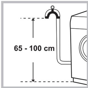
Bez savijanja spojte odvodnu cijev na odvodni cjevovod ili odljev u zidu, koji moraju biti u visini od 65 do 100 cm od poda;
