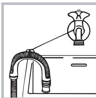
Srijiniți-l de marginea căzii sau chiuveței și racordați șina de ghidare din dotare la robinet (a se vedea figura). Capătul liber al furtunului de golire nu trebuie să rămână cufundat în apă.
