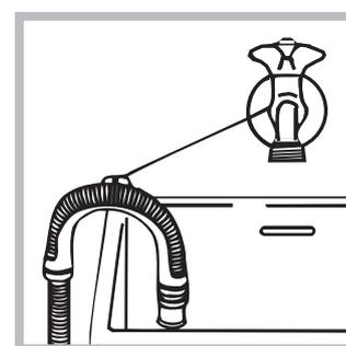
! استفاده از شلنگ های اضافی و رابط توصیه نمی شود؛ اگر واقعاً ضرورت دارد، قطر شلنگ اضافی باید دقیقاً برابر شلنگ اصلی بوده و طول آن نباید از 150 سانتیمتر بیشتر باشد.
