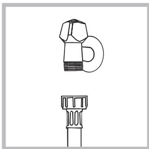
2. شلنگ ورودی را به ورودی آب متناظر روی ماشین لباس شوئی که در بالا سمت راست پشت دستگاه قرار دارد وصل کنید (شکل را ببینید).
