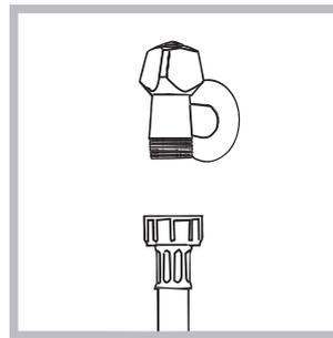
1. Conectați tubul de alimentare, înșurubându-l la un robinet de apă rece cu gura filetată de 3/4 gaz (a se vedea figura). Înainte de conectare, lăsați apa să curgă până când nu a devine limpede.
