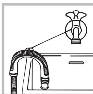
Sprrijiniți-l de marginea căzii sau chiuvetei și racordați șina de ghidare din dotare la robinet (*a se vedea figura*). Capătul liber al furtunului de golire nu trebuie să rămână cufundat în apă.
