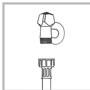
1. Підключити живлячий трубопровід, прикрутивши його до крану холодної води за допомогою штучеру з газовою різьбою 3/4 (див. малюнок). Перед підключенням спустіть воду, доки вона не стане прозорою.
