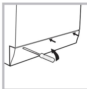
1. rimuovere il pannello di copertura sul lato anteriore della lavabiancheria con l'ausilio di un giravite (*vedi figura*);
