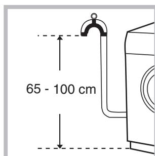
Collegare il tubo di scarico, senza piegarlo, a una condutture di scarico o a uno scarico a muro posti tra 65 e 100 cm da terra;
