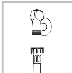
1. Conectar el tubo de agua enroscándolo a un grifo de agua fría con la boca roscada de 3/4 gas (ver la figura). Antes de conectarlo, haga correr el agua hasta que esté limpida.
