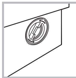
2. desenrosque la tapa girándola en sentido antihorario (*ver la figura*): es normal que se vuelque un poco de agua;
