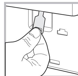
4. utilizando la lengüeta indicada en la figura, tire hacia fuera hasta liberar la varilla de plástico del retén; posteriormente tire hacia abajo y simultáneamente abra la puerta.
