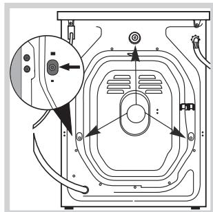
3. Видаліть 3 запобіжні гвинти для транспортування та прокладку з відповідною розріпроною деталлю, які знаходяться позаду (див. малюнок).
