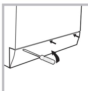
1. свалете панела в предната част на пералната машина с помощта на отвертка (вж. фигура);
