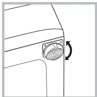
2. Si el piso no está perfectamente horizontal, compense las irregularidades desenroscando o enroscando las patas delanteras (ver la figura); el ángulo de inclinación medido sobre la superficie de trabajo, no debe superar los 2°. Una cuidadosa nivelación brinda estabilidad a la máquina y evita vibraciones, ruidos y desplazamientos durante el funcionamiento.
