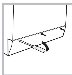
1. tire o painel de cobertura da parte dianteira da máquina de lavar roupa com ajuda de uma chave de fendas (veja a figura);
