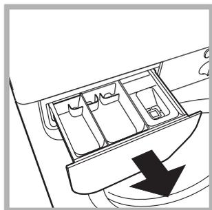
Выньте распределитель, нажав на него с двух сторон и потянув наружу (см. схему)». Промойте распределитель теплой водой. Эта операция должна выполняться регулярно.
