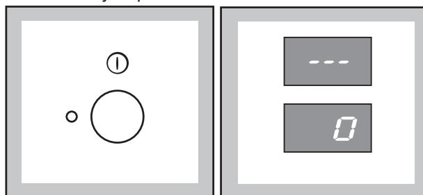
Если селектор программ находится в положении X, то на дисплее появятся три мигающих линии. При других положениях селектора на дисплее появится длительность соответствующей программы.
