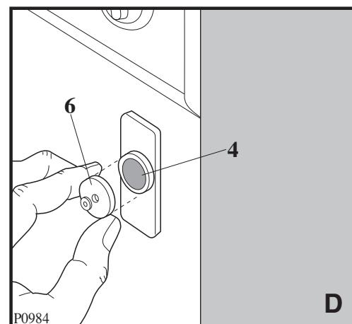
Если дверь должна открываться слева направо, выполните следующее: поменяйте положение пластинок (5-7) и магнита (4). Установите на двери, в правильном положении, ответную часть магнита (6) и петли (1), как описано выше (см. рис. В и Е).
