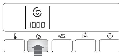
Opakováním stisknutí tlačítka odstředění lze změnit rychlosť odstředění, pokud chcete prádlo odstředit s jinou rychlosťí, než je rychlosť přednastavená pračkou.
