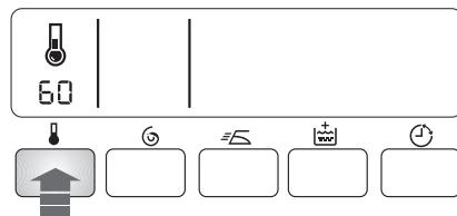
Opakováním stisknutí tohoto tlačítka můžete zvýšit nebo snížit teplotu, chcete-li prádlo vyprat s jinou teplotou, než je teplota navržená pračkou.
