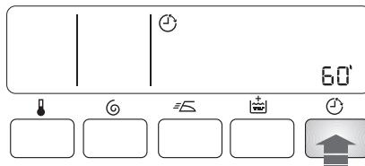
**Před spuštěním programu**, pokud chcete odložit start, stiskněte opakovaně tlačítko Odložený start, k volbě požadovaného odkladu. Příslušná ikona se objeví na displeji v jeho horní části.
