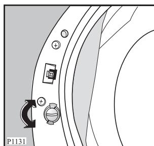
Zařízení se vypne pootočením tlačítka doleva, až je zárez svisle; nyní se dvířka dají opět zavřít.
