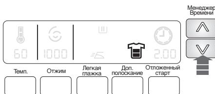
Эта функция позволяет изменять время стирки, автоматически предлагаемое стиральной машиной.
