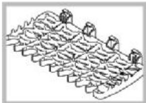
Эти специальные откидные отделения могут использоваться для размещения кружек и чашек. Ложки, вилки и ножи следует размещать в имеющихся ячейках. Рюмки, бокалы можно подвесить за ножки в прорези.
