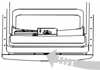
Прокладку дверцы машины, расположенную по периметру дверцы, можно очищать только с помощью мягкой ткани, смоченной теплой водой. Запрещается использовать для этого аэрозольные чистящие средства, так как они могут попасть в запорный механизм дверцы и на электрические компоненты посудомоечной машины.
