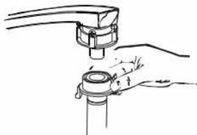
Извлеките соединитель UnicoUPLE вместе с его шлангами из отсека для хранения, который расположен на задней стороне посудомоечной машины, и подсоедините его к переходнику крана.
