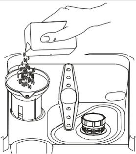
1. Извлеките из машины нижнюю корзину, откройте и снимите крышку контейнера для соли.
