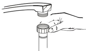
Навинтите соединительную муфту заливного шланга на резьбовой ( $\frac{3}{4}$ ) окончание крана и хорошо затяните. Но прежде, если водопровод новый либо давно не использовался, откройте кран и дайте воде стечь. Убедитесь, что вода чистая, иначе внутренние контуры машины можно засорить.
