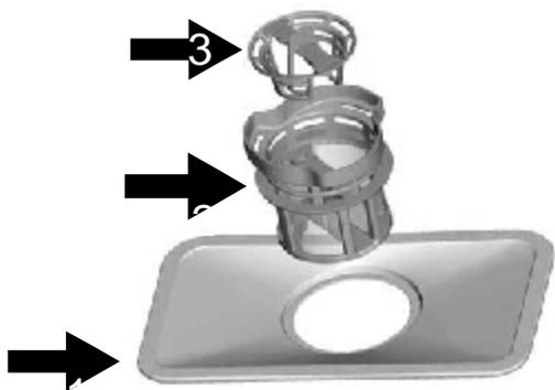
Система фильтрации состоит из фильтра грубой очистки, плоского (основного фильтра) и фильтра тонкой очистки.
