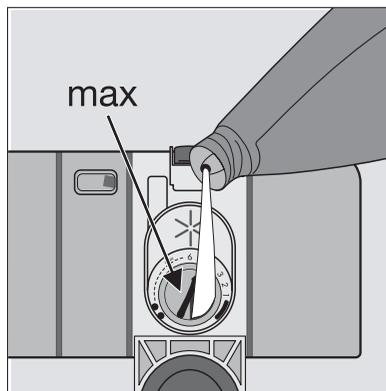
**i** Во избежание избыточного пенообразования при следующей мойке удалите весь пролившийся ополаскиватель куском ткани, хорошо впитывающей жидкость.
