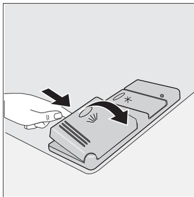
2. Заполните дозатор моющего средства (1) моющим средством. Маркировка указывает на уровни дозирования:
