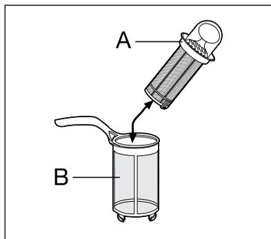
3. Поверните ручку против часовой стрелки примерно на 1/4 оборота и снимите фильтрующую систему.
