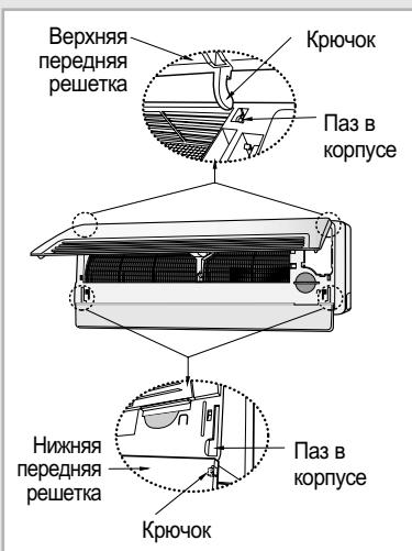
Чтобы получать наилучшие результаты при эксплуатации вашего кондиционера, вы должны регулярно чистить его для удаления пыли, скапливающейся на воздушном фильтре.
