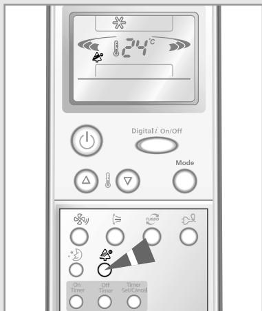
Кондиционер может генерировать анион с ионизатором в комнатном блоке. Так как эта функция является дополнительной, то вы можете выбрать ее в любом режиме, даже если кондиционер выключен.
