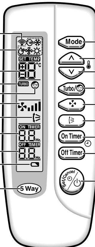
Кнопка выбора режима работы (АВТО, ОХЛАЖДЕНИЕ, УДАЛЕНИЕ ВЛАГИ, ВЕНТИЛЯЦИЯ, ОБОГРЕВ)
