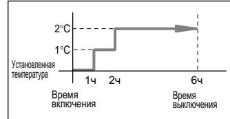
Обогрев Установленная температура понижается на 1°C в час. Когда она понизилась на 2°C (через два часа), температура поддерживается на этом уровне в течение четырех часов.
