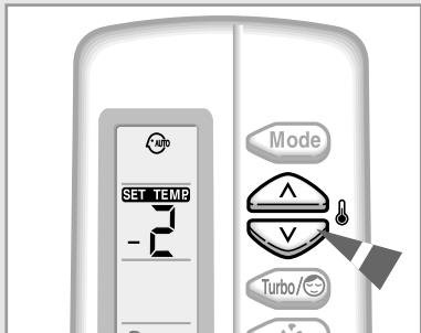
Вы можете включить кондиционер в автоматическом режиме с пульта дистанционного управления. В автоматическом режиме работы автоматически выбираются стандартная температура и оптимальная скорость вентилятора. Вы можете изменить стандартную температуру, но не можете изменить скорость вентилятора.
