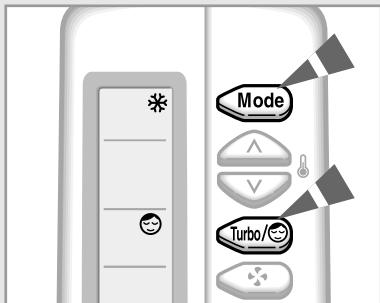
**Таймер "сон" может использоваться при охлаждении или обогреве вашей комнаты для того, чтобы кондиционер автоматически выключался по истечении шести часов.**
