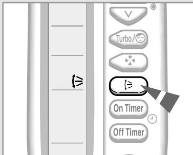
**В зависимости от расположения комнатного блока на стене вашей комнаты, вы можете отрегулировать положение расположенной на нижней поверхности блока наружной пластины, регулирующей воздушный поток, увеличив тем самым эффективность работы вашего кондиционера.**
