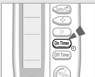
**Таймер включения позволяет автоматически включить кондиционер через определенный промежуток времени. Вы можете установить значение этого промежутка равным от 30 минут до 24 часов.**
