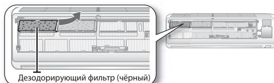
Фильтр-дезодоратор допускается устанавливать в одну из четырех кассет, расположенных под воздушным фильтром
