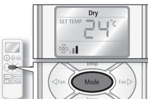
Каждый раз вы нажмите кнопку **Mode**, режим будет изменен в следующие типы: Auto (Авто), Cool (Охлаждение), Dry (Влагопоглощение), Fan (Вентилятор) и Heat (Обогрев).
