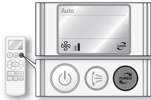
Функция «Turbo» доступна только в режимах «Auto»(Автом.), «Cool»(Охлаждение) и «Heat»(Обогрев). Если включить функцию «Turbo» в режиме «Dry»(Осушение)/«Fan»(Вентилятор), произойдет переключение в кондиционера в режим «Auto»(Автом.).
