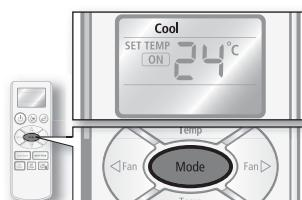
Функция таймера включения(автоматического включения) доступна только в режимах «Auto»(Автом.), «Cool»(Охлаждение), «Dry»(Осушение), «Fan»(Вентилятор) и «Heat»(Обогрев).
