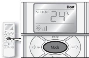
Каждый раз вы нажмите кнопку **Mode**, режим будет изменен в следующие типы: Auto (Авто), Cool (Охлаждение), Dry (Влагопоглощение), Fan (Вентилятор) и Heat (Обогрев).
