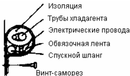
Оберните внешнюю часть обвязочной лентой и выровняйте ее таким образом, чтобы лента повторяла маршрут трубы. Провода и трубы должны быть закреплены на стене зажимами.
