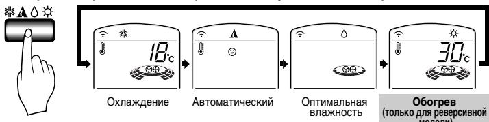
**3** Закройте крышку пульта дистанционного управления. Задайте желаемую температуру (выше, чем текущая). Температура может быть выбрана в диапазоне 16°C–30°C с шагом в 1°C.
