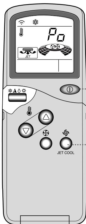
**1** Нажмите кнопку Вкл/Выкл. Модуль выдаст звуковой сигнал.
