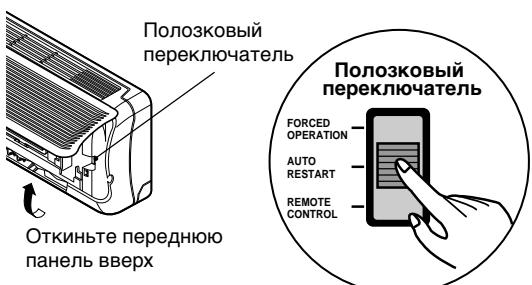
Оставляя кондиционер без присмотра в течение длительного времени, поставьте полозковый переключатель в положение REMOTE CONTROL.
