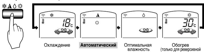
**3** Температура и скорость будут установлены автоматически в зависимости от температуры воздуха в помещении. Для изменения заданной температуры закройте крышку и установите желаемое значение с помощью кнопок установки температуры. В зависимости от того, насколько холодно или тепло в помещении, нажмите на соответствующую кнопку (не более двух раз). Установленная температура автоматически изменится.
