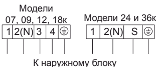
Терминал для подключения проводов на внутреннем блоке
