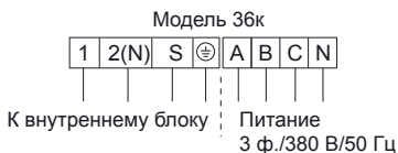
Терминал для подключения проводов на наружном блоке
