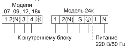
Терминал для подключения проводов на наружном блоке
