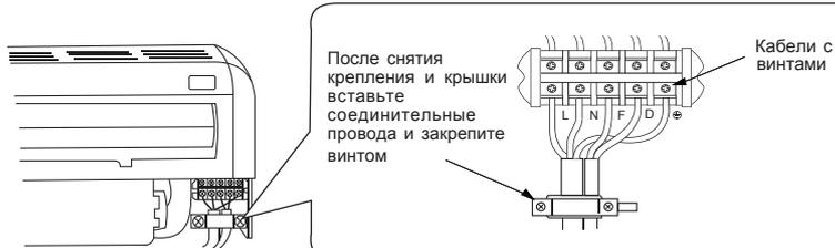
После снятия крепления и крышки вставьте соединительные провода и закрепите винтом
