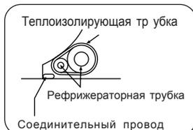
Для облегчения задачи вытяните это вперед при соединении рефрижераторной трубки.
