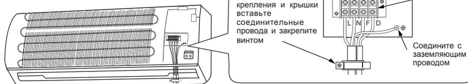
После снятия крепления и крышки вставьте соединительные провода и закрепите винтом
