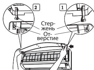
Порядок установки передней панели
