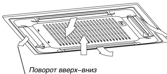
Если качание воздушного потока включено, то включается специальный вентилятор внутреннего блока, меняющий направление потока воздуха. Угол качания потока в каждую сторону составляет  $30^{\circ}$ . Когда кондиционер выключен или находится в режиме готовности, кнопка SWING не работает (кроме случаев, когда установлен таймер включения).
