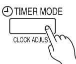
Нажмите и удерживайте кнопку TIMER MODE (CLOCKADJUST) (РЕЖИМ ТАЙМЕРА / НАСТРОЙКА ЧАСОВ) 2 секунды или дольше. Индикатор времени на пульте ДУ будет мигать.
