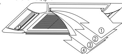
● Вертикальное направление потока воздуха устанавливается автоматически, как показано, в соответствии с выбранным типом работы.
