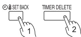
Нажмите кнопку SET BACK (СПЕЦ. ТАЙМЕР), а затем нажмите кнопку TIMER DELETE (УДАЛЕНИЕ ТАЙМЕРА), пока отображается экран подтверждения SET BACK. Даже если повторно нажать на кнопку SET BACK (СПЕЦ. ТАЙМЕР), таймер специальной температуры SET BACK будет отключен.
