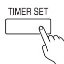
Нажмите и удерживайте кнопку TIMER SET (УСТАНОВКА ТАЙМЕРА) в течение 2 секунд или более, чтобы завершить установку функцию DAY OFF (ДЕНЬ ВЫКЛЮЧЕНИЯ).
