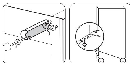
În punga cu documentația există două distanțiere, care trebuie montate ca în figură. Slăbiți șuruburile și introduceți distanțierul sub capul șurubului, apoi strângeți din nou șuruburile.
