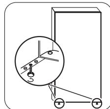
В пакет с документацией вложены две прокладки, которые должны быть установлены, как показано на рисунке. Ослабьте винты и вставьте прокладки под их головки, после чего снова затяните винты.
