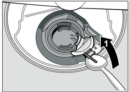
6. Проверьте, не застряли ли между лопастями крыльчатки посторонние предметы и удалите их при наличии.
